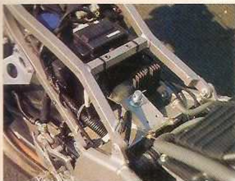
On retrouve comme sur la 750, une fixation supérieure de l'amortisseur arrière qui permet de modifier l'assiette sans toucher aux réglages de suspension.
